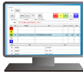
■機種コードを入力すればピッキングが開始されます。また機種コードをバーコード化することで、より簡単＆確実にピッキング作業を開始することも可能です。
